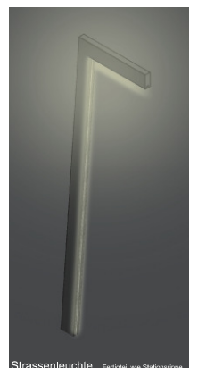
Strassenleuchte - Fertigteil wie Stationsrippe
