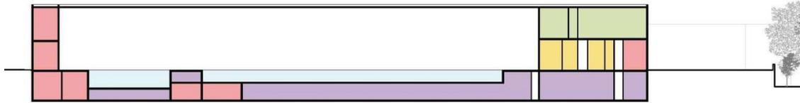
Schematischer Längsschnitt durch die Schwimmhalle: Ersichtlich sind die Zwischengeschosse links und rechts sowie die beiden Becken.
