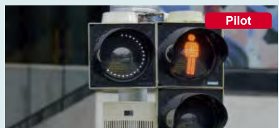
Der Kreis aus LED-Lichter zeigt an, wie lange es noch dauert, bis die Ampel von Rot auf Grün wechselt.
