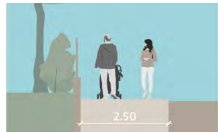
2.50 m genügend für Begegnungsfall FG+ / FG+ bequem für FG / FG
