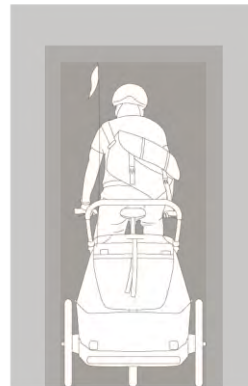
Veloanhänger 1.80 m → Minimum für Hauptrouten
