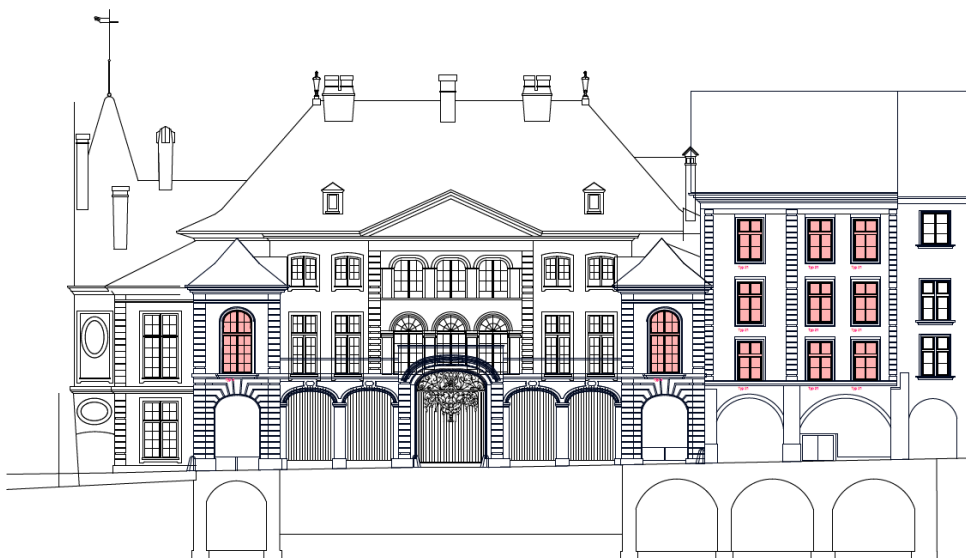
Nordfassade mit den zu ersetzenden Fenstern (rot)
