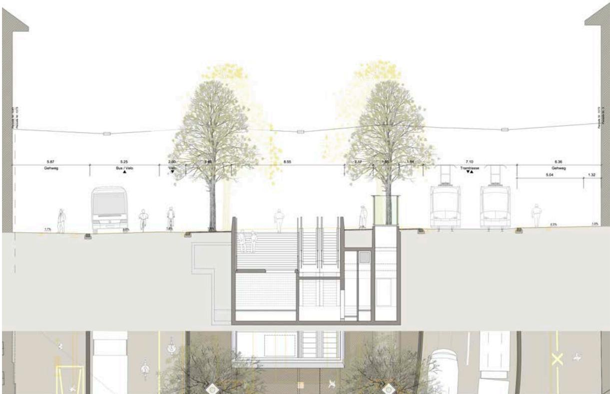
Abb. 3: Neugestaltung Hirschengraben. Querschnitt Passagenaufgang 1:50, 15.3.2022 (verkleinerter Ausschnitt). Gelb dargestellt der zur Fällung vorgesehene Baumbestand.
