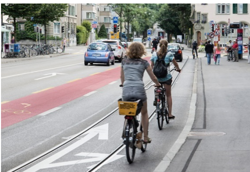
Balanceakt: Die schmale Durchfahrt zwischen Gleis und hoher Haltekante erfordert Geschick und schliesst weniger geübte Velofahrende aus. Mit Anhängern und Cargobikes sind solche Haltestellen äusserst schwierig zu durchfahren.
