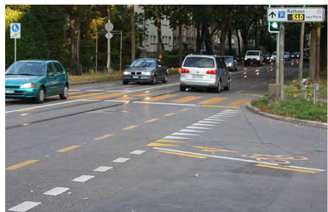
Bei starker Verkehrsbelastung durch den MIV oder bei Tramgleisen kann das indirekte Linksabbiegen als Zusatzangebot geprüft werden. Die Anlage auf der Muristrasse (Bild) weist eine bedarfsgesteuerte Lichtsignalanlage auf.
