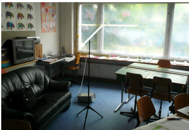
Abb. 5: Zimmer 3/003, Raumluftmessung nach Abschluss der Sanierungsarbeiten
