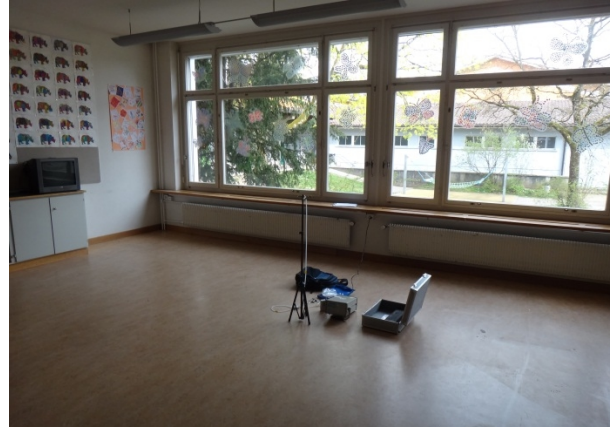
Abb. 2: Zimmer 3/003, Raumluftmessung vor Probesanierung
