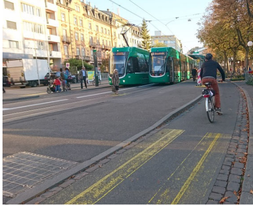
Haltstellenumfahrung: Die selbsterklärende Anlage benötigt keine Signalisation zur Zuordnung der Fuss- und Veloverkehrsflächen. Bild: Kasernenstrasse, Basel.
