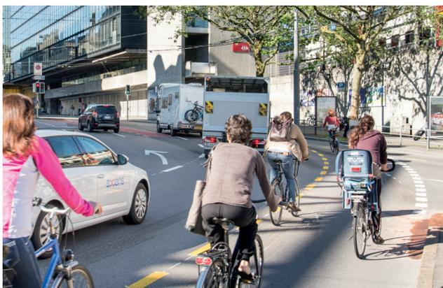
Durchgängiger und ausreichender breiter Radstreifen (2.50 m) beim Bollwerk. Der Radstreifen garantiert hier einen ausreichenden Abstand zum motorisierten Verkehr und die notwendige Kapazität in den Spitzenstunden.
