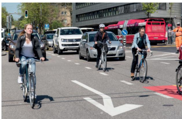
Häufig fehlt der Platz, um Radstreifen auf allen Fahrbeziehungen anbieten zu können. Demgegenüber ist das indirekte Linksabbiegen platzsparender und ermöglicht zugleich breitere Radstreifen am rechten Fahrbahnrand.
