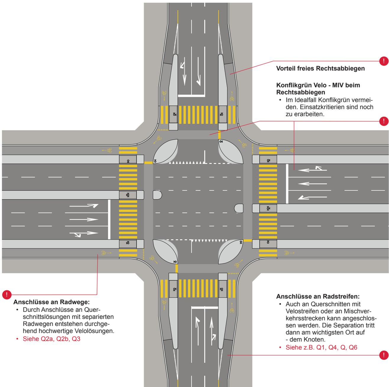
Die Knotenlösung nach niederländischem Modell ist neu für die Schweiz. Die Lösung macht vor allem an **sehr stark belasteten Knoten** mit **genügend Platz** Sinn. Zur Einordnung in die räumliche Situation in Bern ist nachfolgend eine Auswahl an Knoten aufgeführt, an denen der Einsatz aus Velosicht grundsätzlich denkbar ist.
