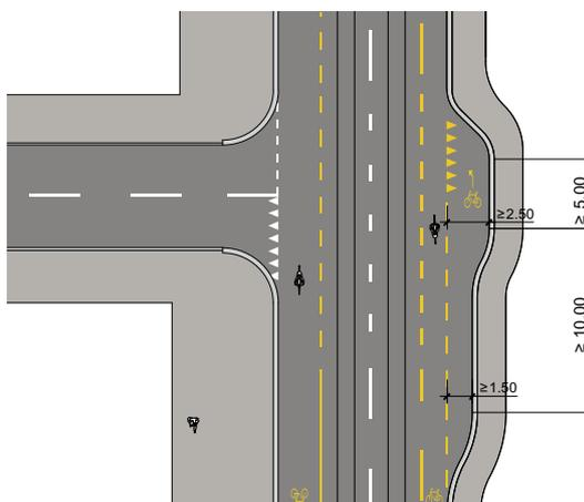
Bei T-Knoten mit hohen MIV-Belastungen und einer hohen Velonachfrage kann eine Abbiegehilfe am rechten Fahrbahnrand erstellt werden. Dargestellt ist der Idealfall aus Sicht des Veloverkehrs. Es sind auch reduzierte Varianten machbar.
