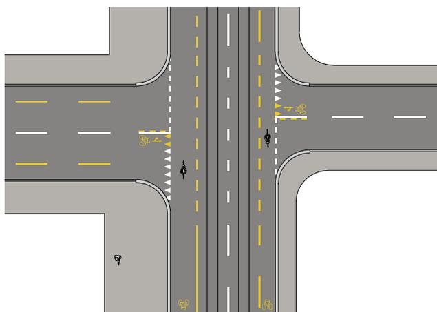
Bei besonderen Verhältnissen, namentlich bei Knoten mit Tramschienen und ohne Abbiegehilfe in der Mitte, kann eine Linksabbiegehilfe in der Querfahrbahn erstellt werden. **Da ein Konflikt mit dem einmündenden Verkehrsstrom in der Querfahrbahn besteht, sind die Voraussetzungen sorgfältig zu prüfen.**
