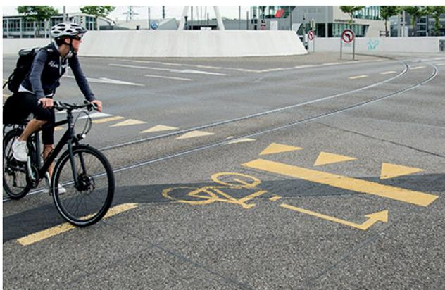
Wankdorfplatz. Das Linksabbiegen erfolgt indirekt via Querfahrbahn. Die dortige Grünphase folgt in der Regel rasch, so dass keine grossen Zeitverluste entstehen.
