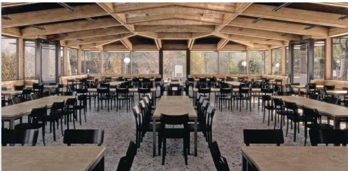
Der Neubau verfolgt konsequent die Idee des «Gartensaals», dessen grossen Klappflügel Fenster die (Klima-) Grenze zum Aussenraum bewusst aufweichen. Dieser Logik folgend ist die Haustechnik bewusst einfach gehalten. Geheizt wird mit der bestehenden Grundwasserpumpe. Mit Radiatoren kann kurzfristig auf Personendichte und Aussentemperaturen reagiert werden. Die Lüftung erfolgt hauptsächlich über Nachströmklappen, die auch der Nachtauskühlung dienen.
