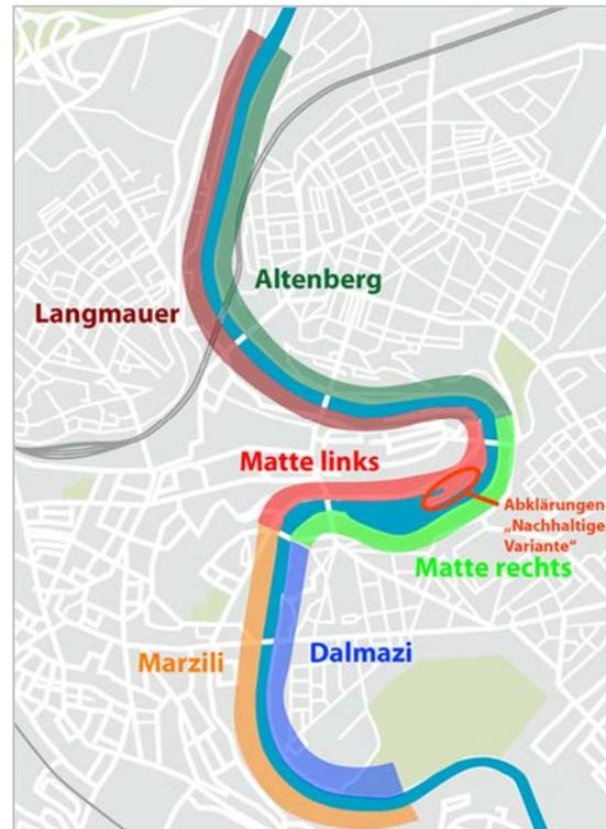
So wird etwa im Dalmaziquartier auf eine „städtebaulich motivierte“ durchgehende Ufermauer verzichtet und stattdessen lediglich dort, wo es aus Hochwasserschutzgründen angezeigt ist, eine Mauer mit reduzierter Höhe eingeplant. Im Bereich Altenberg wird auf die ursprünglich vorgesehenen unterirdischen Abdichtungen und auf einzelne Massnahmen im unteren Abschnitt verzichtet.
