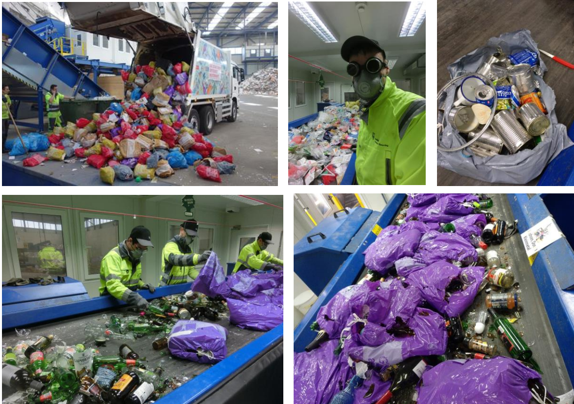
Abb. 3.4: Impressionen der Analyse der Farbsäcke. Im Bild unten rechts ist ersichtlich, dass viele Glassäcke durch den Transport innerhalb der Förderbandanlage zerrissen wurden und folglich viel loses Glas im Recyclingstrom landet.
