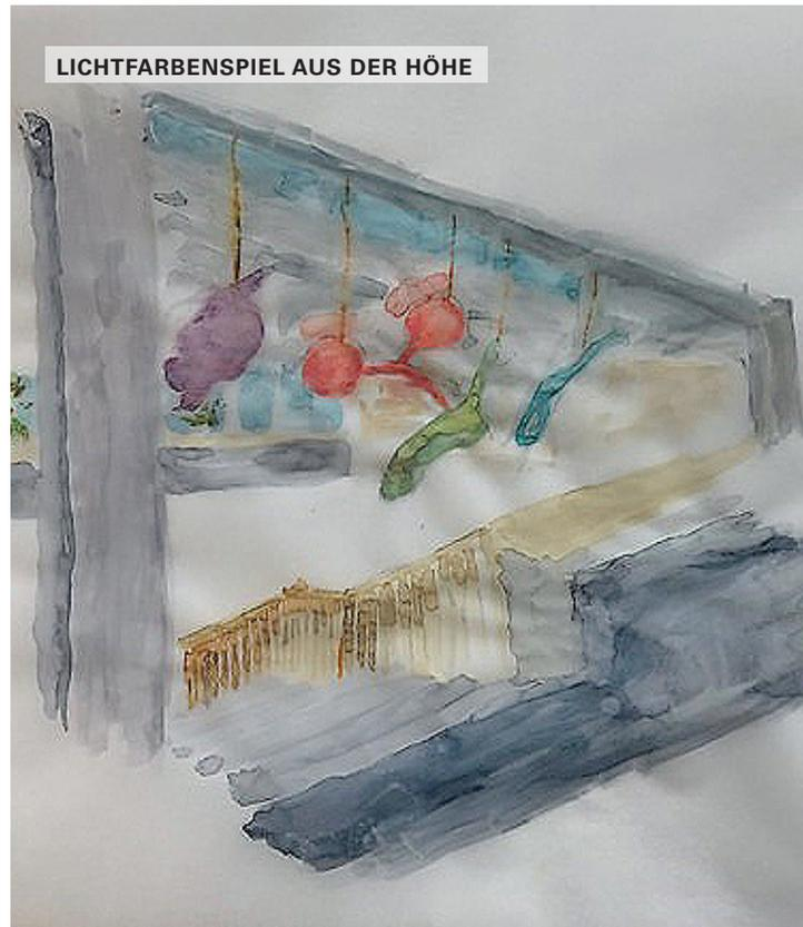
mundgeblasenen Glasstücke eingefärbt und gleichzeitig Sicherheitsüberlegungen standhalten mussten. Die Grösse der Glasstücke musste geringfügig redimensioniert und die pigmentierten Farben in ein VSG-Glas gepackt werden.
