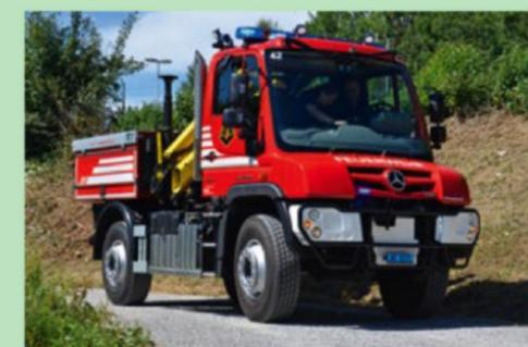
Ein Pionierfahrzeug ist dieser Mercedes Unimog U 427 mit Kran und heckseitiger Seilwinde.
