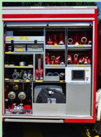
Neben Schläuchen und Armaturen lagern in G2 auch die Schneeketten. Links davon zwei B-Abgänge und Füllleitung für den Schaumtank. Neben dem Display zur Bedienung der Pumpe der Tankfüllstutzen für Diesel.
