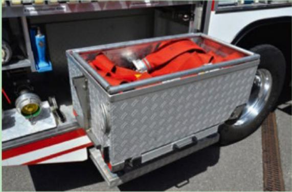
Wasserversorgung leicht gemacht. Diese sogenannte Zubringerkiste mit zwei 75-mm-Druckschläuchen, zwei 55-mm-Druckschläuchen sowie Hydrantenanschlussstück und Schlüssel kann auf Rollen gezogen werden, um eine schnelle Wasserversorgung herzustellen.
