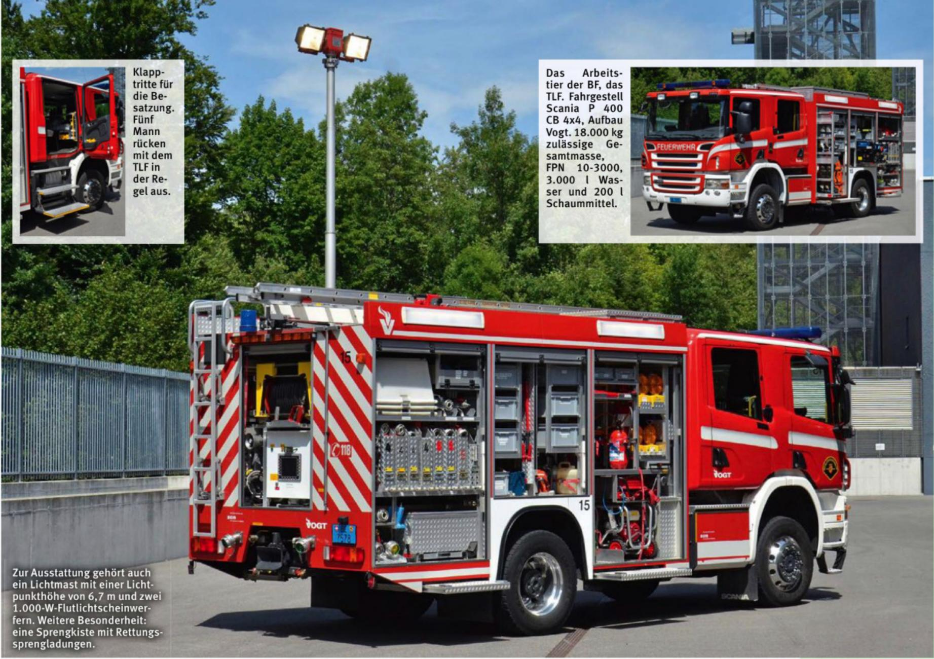
Zur Ausstattung gehört auch ein Lichtmast mit einer Lichtpunkthöhe von 6,7 m und zwei 1.000-W-Flutlichtscheinwerfern. Weitere Besonderheit: eine Sprengkiste mit Rettungssprengladungen.
