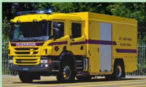
Neuestes Fahrzeug im Stall ist dieser große GW-G von Brändle auf einem Scania P450. Vier Mann Besetzung haben auf dem Fahrzeug Platz. Über die Ladebordwand ist der hintere Geräteraum mit den Rollwagen erreichbar.
