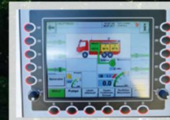
Blick auf das Bedienfeld für die Löschtechnik im G-TLF. Vier B-Abgänge rechts und links sowie einer an der Front sind vorhanden. Auch Schaummittel kann hierüber beigegeben werden.
