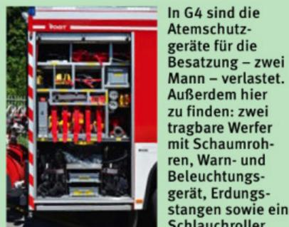
In G4 sind die Atemschutzgeräte für die Besatzung – zwei Mann – verlastet. Außerdem hier zu finden: zwei tragbare Werfer mit Schaumrohren, Warn- und Beleuchtungsgerät, Erdungsstangen sowie ein Schlauchroller.
