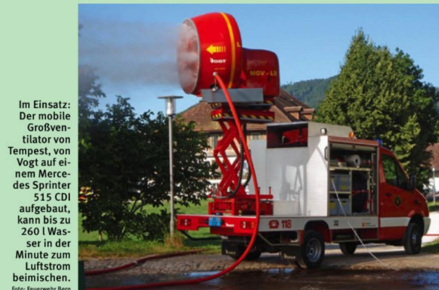
Im Einsatz: Der mobile Großventilator von Tempest, von Vogt auf einem Mercedes Sprinter 515 CDI aufgebaut, kann bis zu 260 l Wasser in der Minute zum Luftstrom beimischen.
