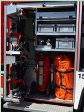
Atemschutzgeräte sind auf einer Drehwand gelagert. Dahinter steht ein fahrbarer 50-kg-Pulverlöscher, daneben ist das Sprungpolster System Lohrsbach gelagert. Geräteräume heißen hier übrigens Caisson.
