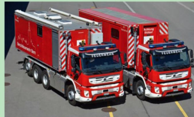
Die beiden baugleichen WLF der Feuerwehr Bern basieren auf Volvo FMX 460/8x4 R Tridem. Auf den 8,37 m langen Fahrzeugen ist jeweils ein Hakengerät Hiab Multilift XR20ZL.56 montiert. Zulässige Gesamtmasse: 32.000 kg je Fahrzeug. Aufgesattelt sind ein AB-Führung und ein AB-Atemschutz.
