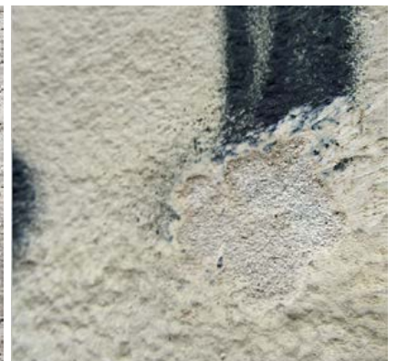
Beispiel einer deckend gestrichenen, abtrocknenden Farbe: hier Kasein auf Sandstein
