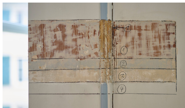
Abb. 02 – Stratigraphischer Untersuch zur Ermittlung der Farbschichten. Foto: Simon Opladen
