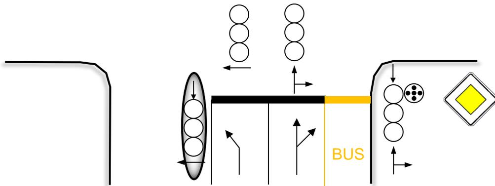
Abbildung 15: Anzahl Signalgeber zwei Fahrstreifen Haupttrichtung und Busfahrstreifen.
