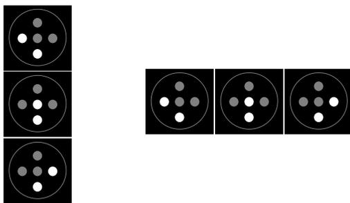
Abbildung 59: Vertikale und horizontale Montagereihenfolge: links, geradeaus, rechts.
