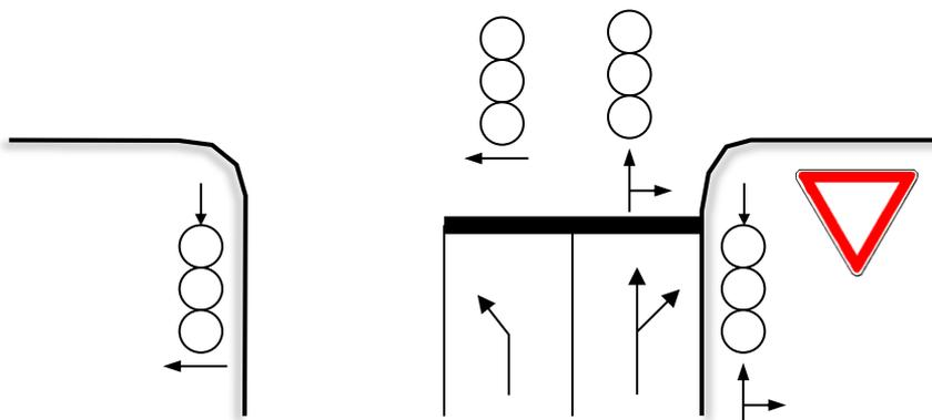
**Abbildung 18: Anzahl Signalgeber zwei Fahrstreifen Nebenrichtung ohne Insel.**
