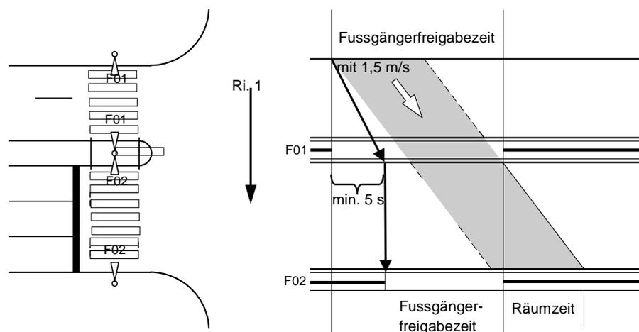
**Abbildung 49: Versetzte Gehenzeit (min. 5s,  $v_{FG} = 1,5$  m/s).**
