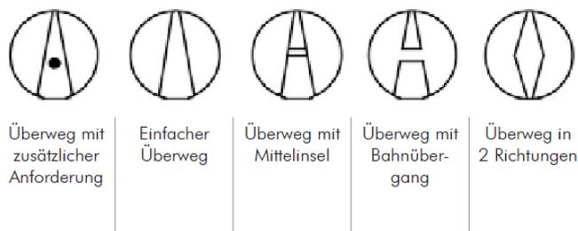
Abbildung 32: Überblick über Richtungspfeile.
