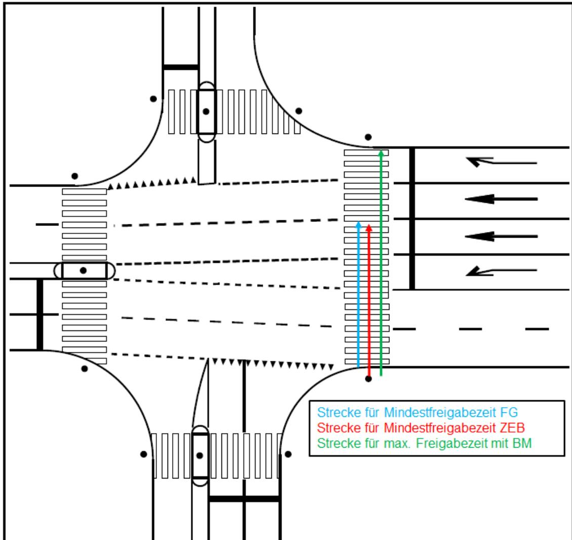
Abbildung 46: Strecken für Freigabezeiten bei FG-Übergängen ohne Schutzinsel.
