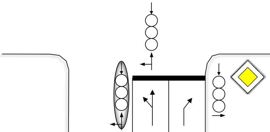
Abbildung 13: Anzahl Signalgeber zwei Fahrstreifen, Haupttrichtung mit Insel (2).
