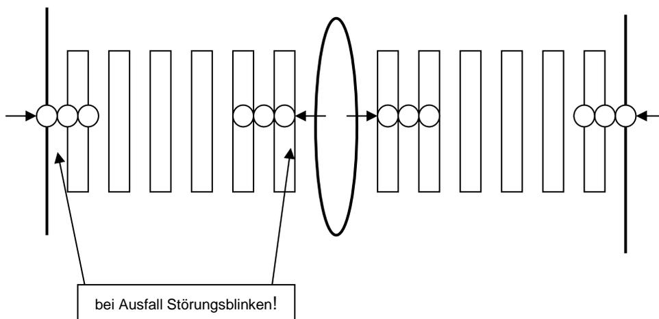
Abbildung 7: Rotlampenüberwachung FG-Übergang.
