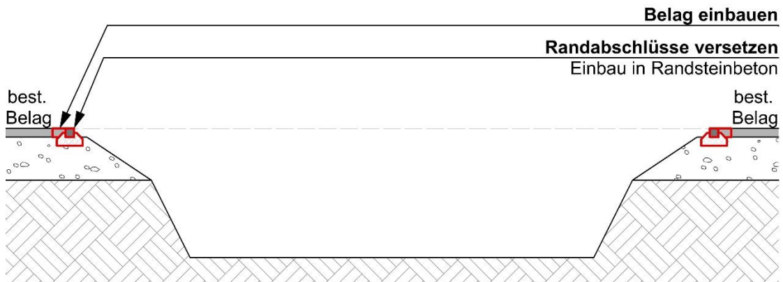
Abbildung 2: Belagseinbau und Randabschlüsse, Quelle: Stadtgrün Bern
