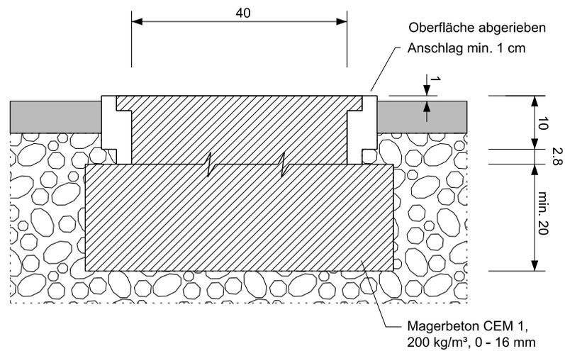
Nach dem Aushärten des Betons wird der Helvetia Abfallbehälter 110 l (Durchmesser 47.8 cm, Höhe 109.0 cm) auf das Fundament aufgeschraubt.
