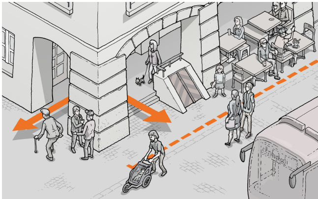
Der freie Laubendurchgang ermöglicht ein ungehindertes Zirkulieren von Fussgängerinnen und Fussgängern.
