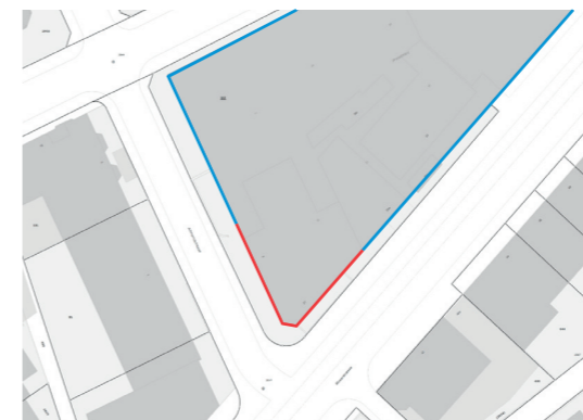
Abb. 3: projektierte Baulinie an der Ecke Moser- / Allmendstrasse (blaue Linien = Baulinien genehmigt; rote Linien = Baulinien projektiert)
