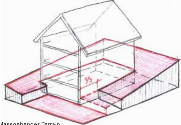
Massgebendes Terrain bei Abgrabung
