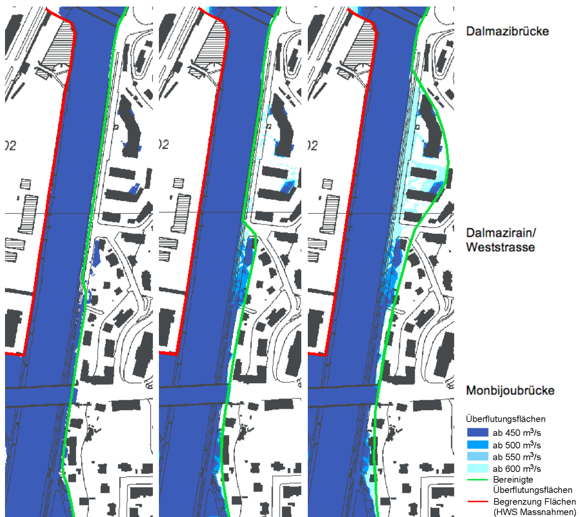
Abbildung 13: Überflutungsflächen Dalmazi bei 450 m 3 /s (links), 550 m 3 /s (Mitte) und 600 m 3 /s (rechts) nach Massnahmen. Überflutung linksseitig durch HWS-Massnahmen begrenzt (Projekt). Effektive Überflutungsflächen rechtsseitig pragmatisch durch grüne Linie abgegrenzt (keine Massnahmen).
