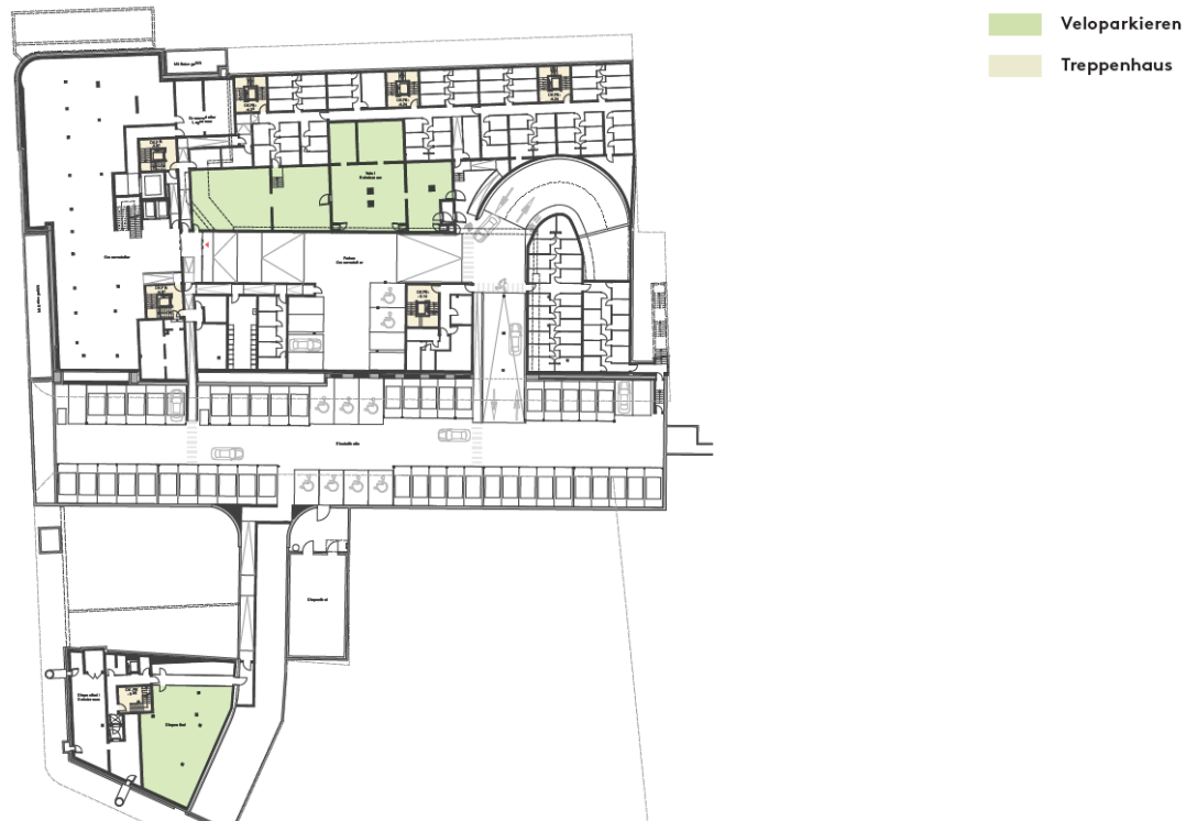
Untergeschoss - Veloparkieren unterirdisch - Stand Vorprojekt 31.01.2018
