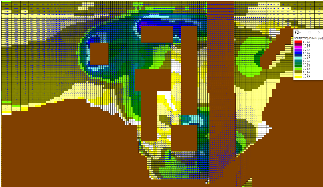
Abbildung 13: Windfeld und Turbulenz im Projekt 4-HBF auf 552m ü.M. Braun eingefärbt alle Bereiche, die auf dieser Höhe entweder überbaut oder im Gelände liegen.
