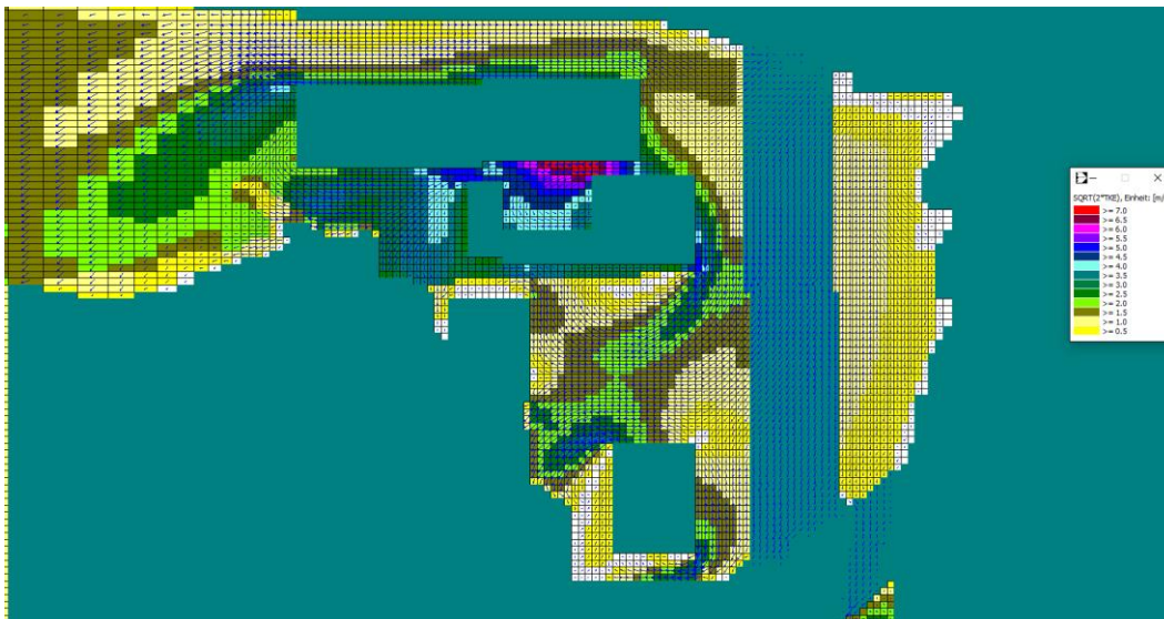
Abbildung 18: Windfeld und Turbulenz im Projekt 3-NW auf 549m ü.M. Grün eingefärbt alle Bereiche, die auf dieser Höhe entweder überbaut oder im Gelände liegen.
