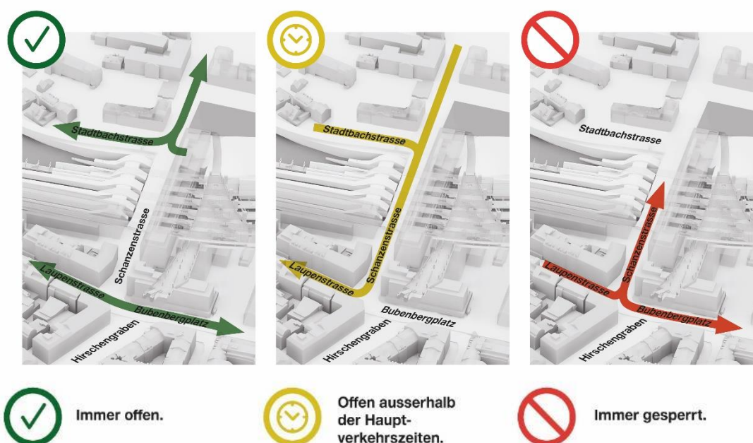
Abb. Nr. 4: Neue Abbiegebeziehungen Laupenstrasse / Bubenbergrplatz / Schanzenstrasse
