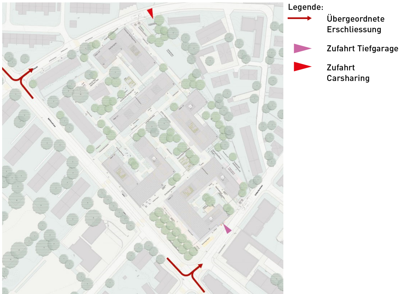
Abbildung 13: Erschliessung MIV gemäss Richtprojekt (Stand April 2024)
