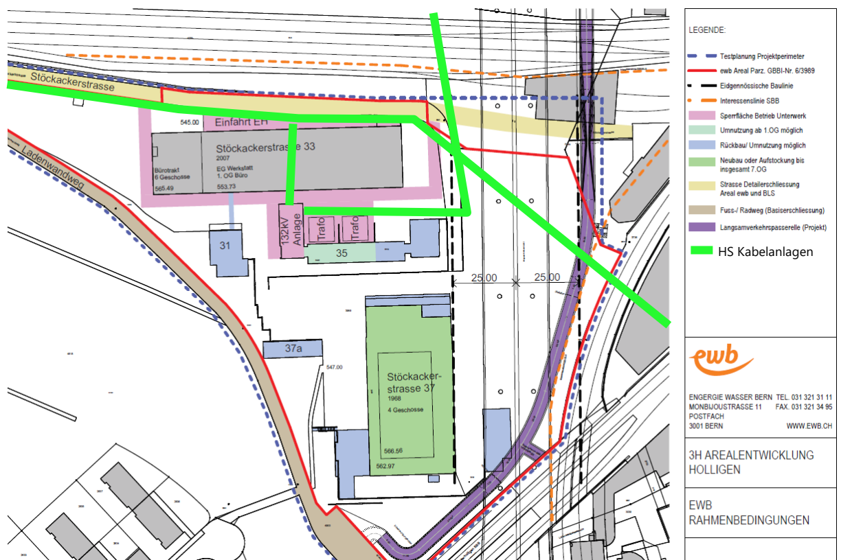
Abbildung 11: Ausschnitt Plan EWB Rahmenbedingungen mit Trafostandorten und Sperrflächen für Betrieb Unterwerk (rosa Fläche). (Quelle: ewb, 18.05.2015)
