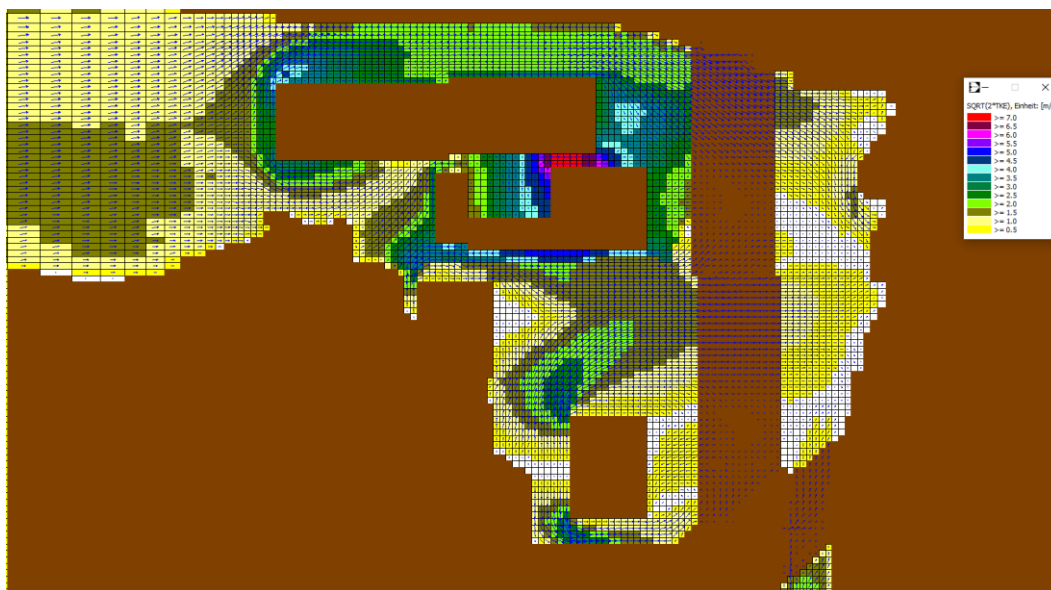
Abbildung 14: Windfeld und Turbulenz im Projekt 3-NW auf 549m ü.M. Braun eingefärbt alle Bereiche, die auf dieser Höhe entweder überbaut oder im Gelände liegen.
