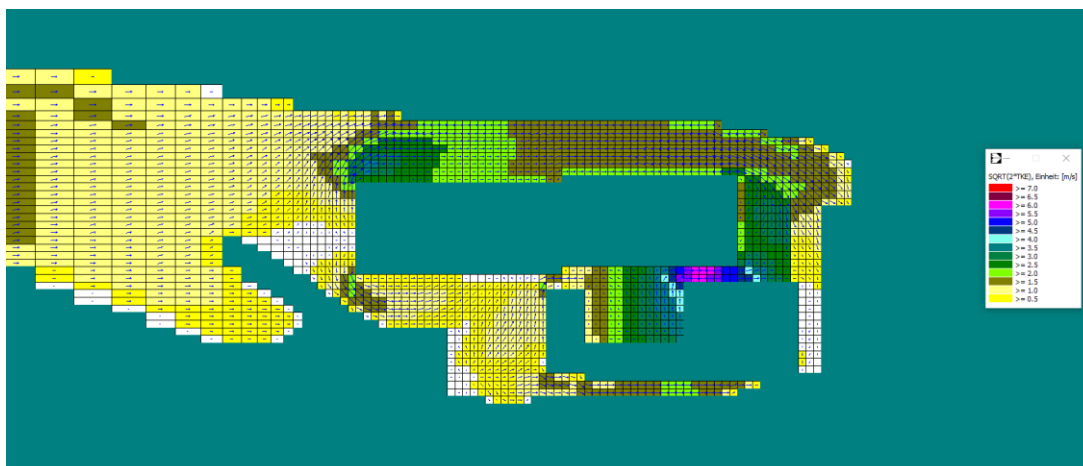
Abbildung 7: Windfeld und Turbulenz im Projekt 3-NW auf 547m ü.M. Grün eingefärbt alle Bereiche, die auf dieser Höhe entweder überbaut oder im Gelände liegen. Dargestellt ist der nördliche Teil des Areals mit der Bahnlinie (grüner Bereich oben) und der Autobahnbrücke (rechts). Klar sichtbar die hohe Turbulenz zwischen dem bestehenden Gebäude (Mitte) und dem neuen Hochhaus.
