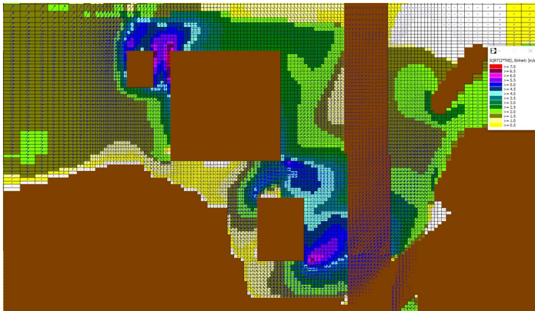
Abbildung 11: Windfeld und Turbulenz im Projekt 2-BB auf 552m ü.M. Braun eingefärbt alle Bereiche, die auf dieser Höhe entweder überbaut oder im Gelände liegen.
