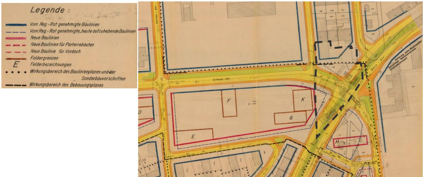
Abbildung 9: Ausschnitt aus der Überbauungsordnung (Baulinienplan) Schwabgut II 1965, mit schwarz gestricheltem Perimeter der Zone mit Planungspflicht
