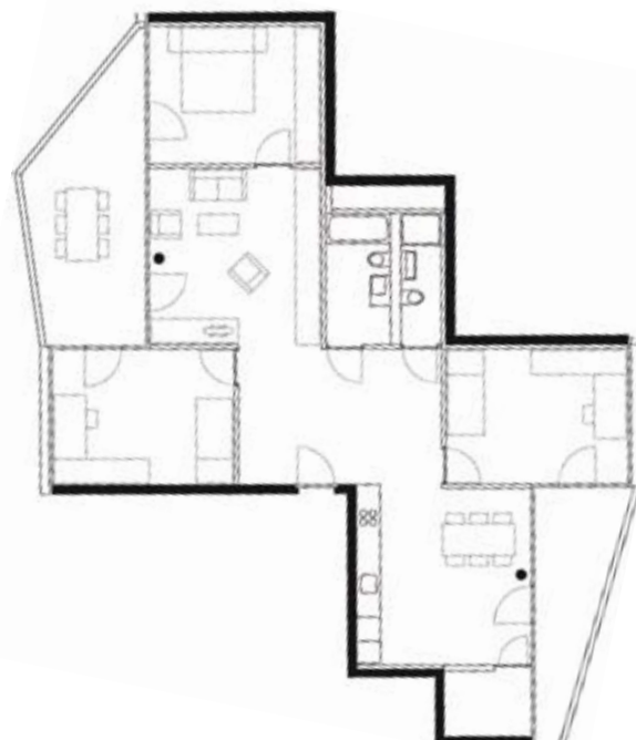
Grosszügige Diele als zentraler Verteiler zu den verschiedenen Wohnbereichen in der Überbauung Hardegg
