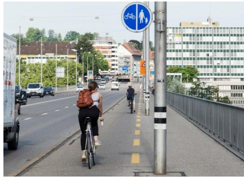
Auf der Monbijoubücke sind die Flächen für den Fuss- und Veloverkehr durch eine markierte Linie getrennt. Dementsprechend kommt das Signal 2.63 zur Anwendung.
