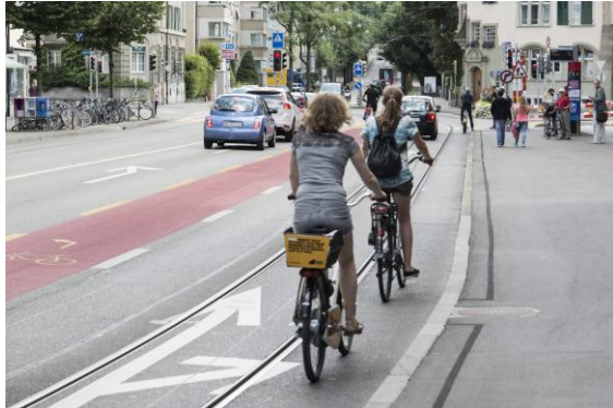
Kapphaltestelle Sulgenau, Monbijoustrasse: Die enge Durchfahrt zwischen der Haltekante und den Gleisen stellt eine Gefahrenstelle dar, im Besonderen mit Cargo-Bike oder Veloanhänger. Für weitere Hinweise siehe auch Kapitel 9, Haltestellen, sowie die entsprechenden Seiten im Dokument «Standards».
