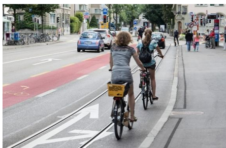
Balanceakt: Die schmale Durchfahrt zwischen Gleis und hoher Haltekante erfordert Geschick und schliesst weniger geübte Velofahrende aus. Mit Anhängern und Cargobikes sind solche Haltestellen äusserst schwierig zu durchfahren.
