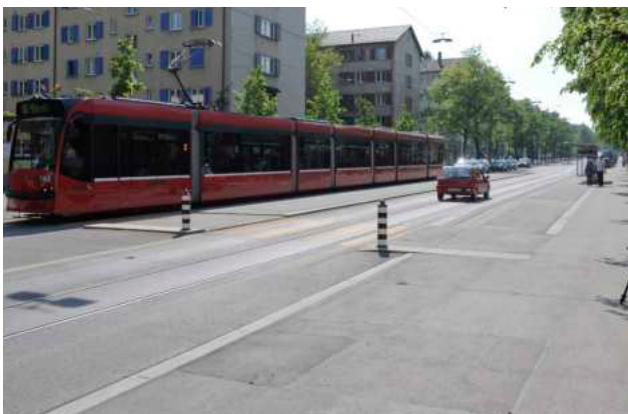
Schlossmatte, Bern. Vergleichsweise tiefe MIV-Belastung, Kapvorsprung mit niedrigem Randabschluss, so dass ein Ausweichen des Veloverkehrs ermöglicht wird.
