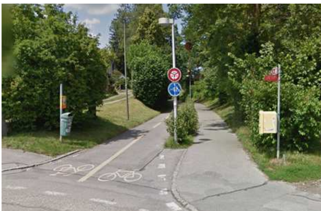
Radweg Wabern-Schönausteg: Aufgrund der Längsneigung und Frequenz ist hier eine Trennung zum Fussverkehr sinnvoll.
