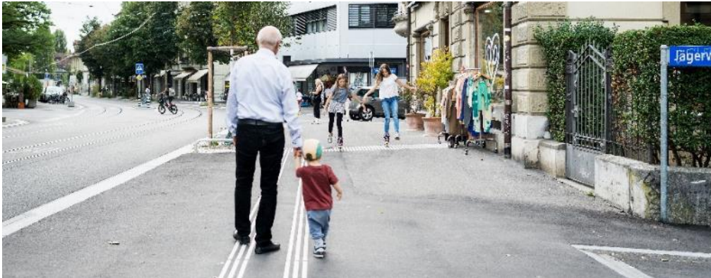
Durchgehendes Trottoir am Knoten Moserstrasse/Jägerweg mit Leitlinien.
