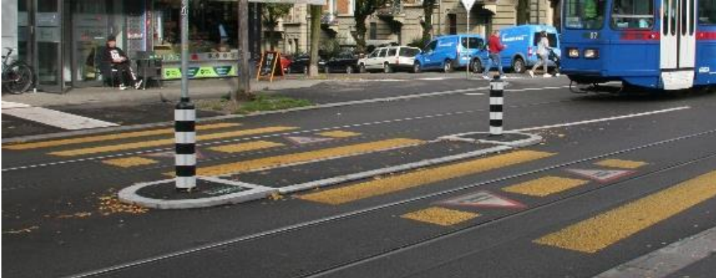
Fussgängerstreifen über Tramschienen im Mischverkehr mit «Achtung Tram»
