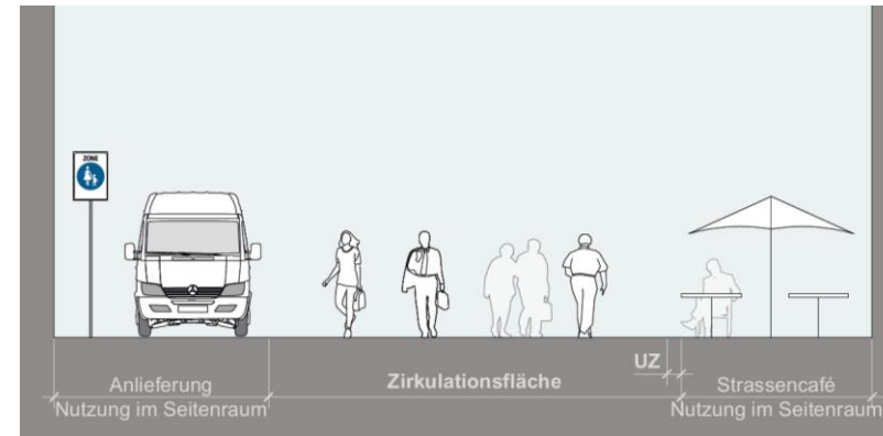
Beispiel Querschnitt einer Fussgängerzone in der Innenstadt.
