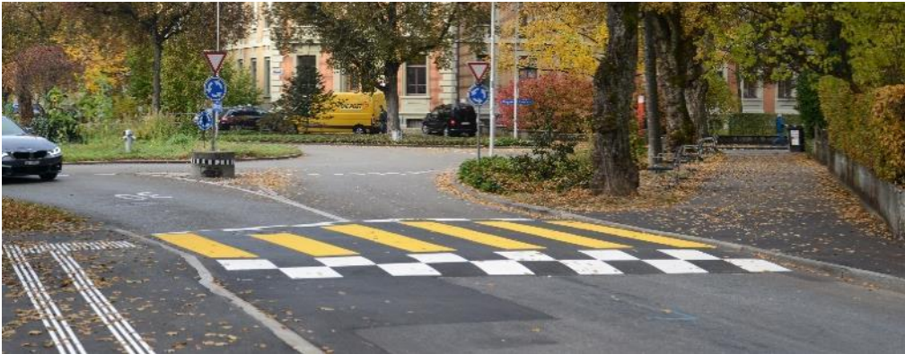
Fussgängerstreifen in Kombination mit Anhebung der Querungsstelle (Bühlstrasse).
