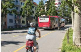
Ununterbrochener und breiter Radstreifen (2,25m) bei der Steigung zur Wylelegg. Überholen ist innerhalb des Radstreifens möglich und zum Bus besteht ein ausreichender Sicherheitsabstand.
