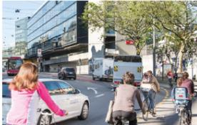
Durchgängiger und ausreichend breiter Radstreifen (2,50m) beim Bollwerk. Der Radstreifen garantiert hier einen ausreichenden Abstand zum motorisierten Verkehr und die notwendige Kapazität in den Spitzenstunden.
